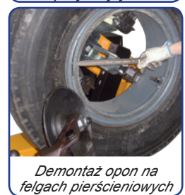
Demontaż opon rolniczych przy pomocy specjalnej łyżki
